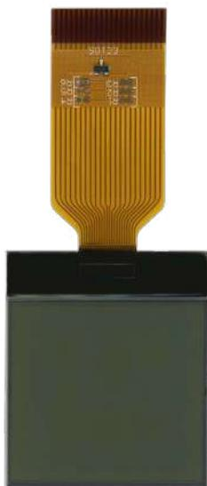
Display LCD 64x64 pixel, completo di flat, adattabile ai quadri strumenti / contatore di vari trattori New Holland:
